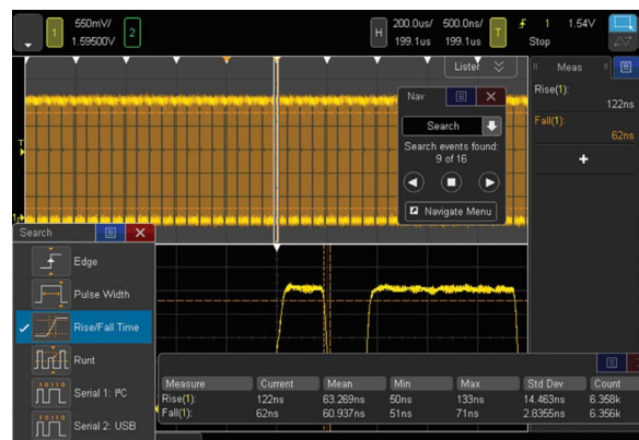
Рис. 10а. Осциллограф серии 4000 X настроен на захват сигналов с различным временем нарастания фронта. Использование функций поиска и навигации позволило найти, отметить (белые треугольники) и быстро перемещаться между шестнадцатью событиями, не соответствующими заданным критериям по времени нарастания фронтов.
