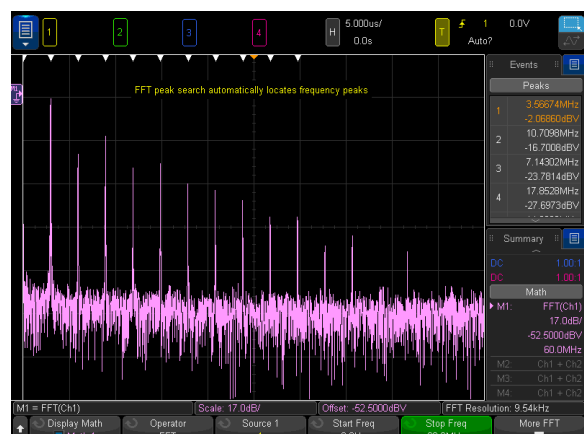
Рис. 10б. Осциллограф серии 4000 X настроен на захват тактовых сигналов для анализа с помощью функции БПФ. Использование функций поиска и навигации позволило найти, отметить (белые треугольники) и быстро перемещаться между первыми одиннадцатью частотными пиками. Их можно отсортировать по частоте или амплитуде.
