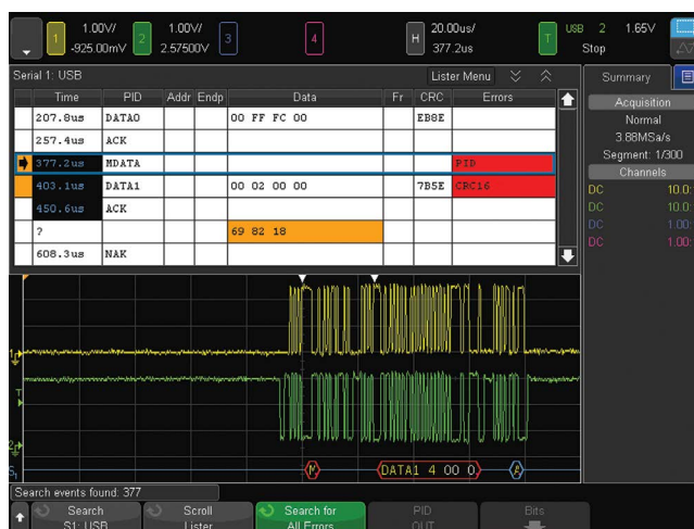
Рис. 21. Запуск, декодирование и отображение в режиме «Lister» сигнала шины USB 2.0.
