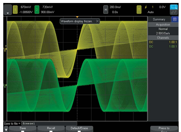
Рис. 43. Функция фиксации информации на дисплее обеспечивает отображение осциллограмм с градацией яркости при остановке сбора данных.
