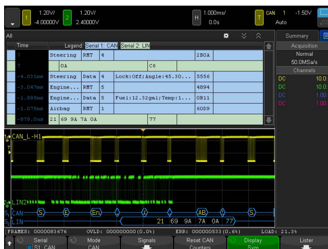
Рис. 20. Одновременное декодирование сигналов шины CAN и LIN и их отображение в режиме «Lister».
